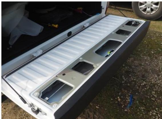
**4) Retirez les deux boulons qui maintiennent la poignée du hayon (à l'intérieur). Déclipsez la tige de verrouillage**
