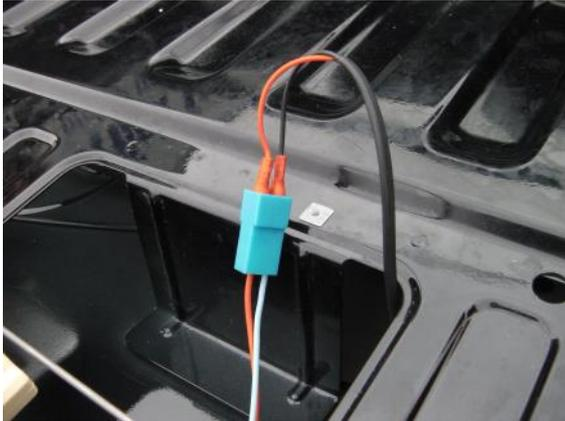
**10)** Faites sortir le faisceau de câbles du hayon par le trou situé au centre de hayon
