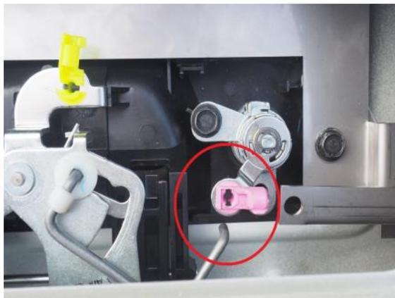
**7) Fixez la serrure électrique au barillet de verrouillage du véhicule (utilisez le nouveau clip de verrouillage de la tige fourni). Réinsérez la tige de verrouillage sur le nouveau clip.**
